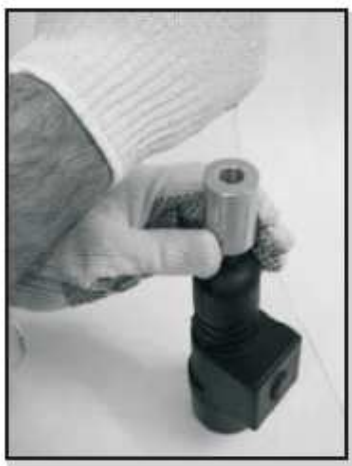
Ação manual para a retirada do cartucho
