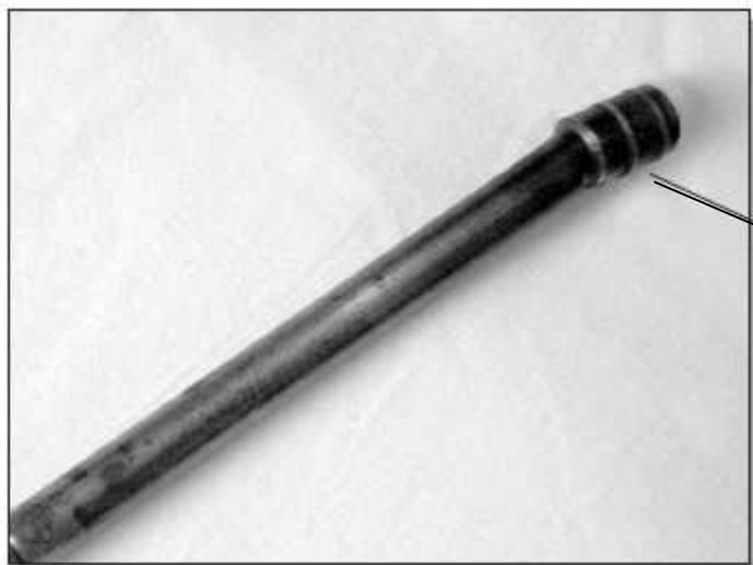
▶ Êmbolo avariado na extremidade
